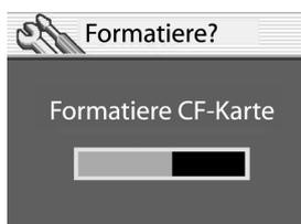
Eine Fortschrittsleiste in der Bildanzeige gibt an, dass die Kamera gerade die CF-Speicherkarte formatiert. Während der Formatierung der CF-Speicherkarte, dürfen Sie die Klappe des Fachs für CF-Speicherkarten nicht öffnen, um Schäden an der Karte zu vermeiden.
