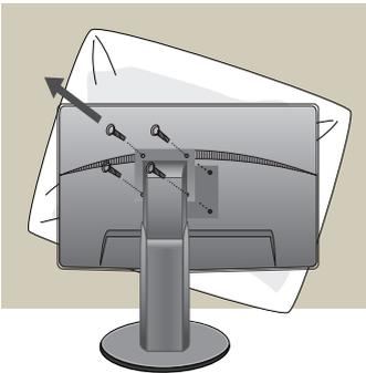
2. Entfernen Sie den Standfuß mithilfe eines Schraubenziehers.
